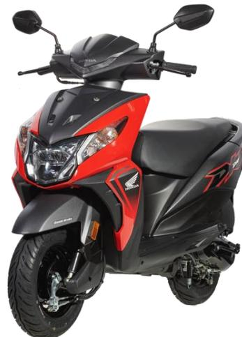
La nueva edición 2024 viene equipada con un motor de 4 tiempos, que ofrece una potencia de 7.65 Hp / 7,750 rpm y una cilindrada de 108.9 cm<sup>3</sup>. Su tanque de gasolina es de 5.3 litros, es la opción ideal para aquellos que buscan obtener un gran rendimiento urbano.
